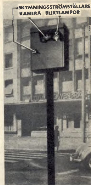
Så ser den ut, den nya trafikövervakningsanläggningen modell/Siemens-Agfa — mitt på Platz der Republik i Frankfurt a.M.
