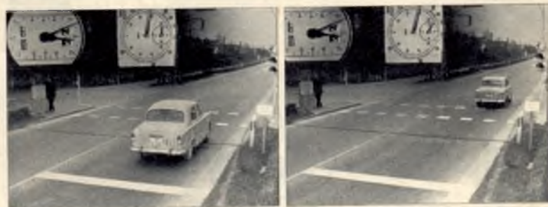
Stoppljusövervakning vid Germering i München: bilden t.v. visar första fotot taget 5,3 sekunder efter den gula signalens början, medan bilden t.h. är det andra fotot, taget 1 sekund senare.
